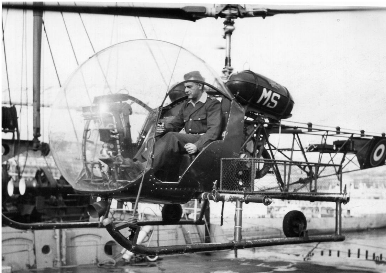
Décollage du Léon-Mazella, à d'Alger fin décembre 1956. Aux commandes, le capitaine Durand. La cage grillagée sur le côté était destinée à recevoir des jerricans, les outils et enfin, à Port Fouad, un légionnaire armé d'un FM (photo Michel Salmon).
